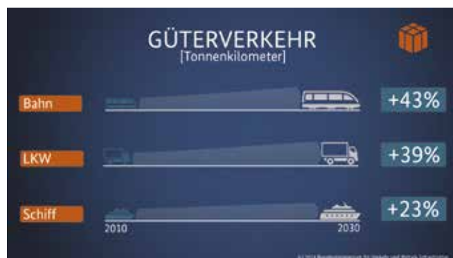
Auch wenn der Güterverkehr über die Bahn besonders ansteigen wird, belastet die fast 40%ige Steigerung des LKW-Verkehrs unser Straßennetz.
