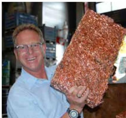
Horst Beck demonstrierte, wie die mehrere Tonnen schweren Seekabel beispielsweise mit einer Baggerschere vorgeschnitten und dann in die Anlage eingelegt werden. Das am Ende gewonnene Kupfer ist ein wertvoller Rohstoff und wird unter anderem für Wasserleitungen, für neue Kupferkabel und auch in der Handyproduktion eingesetzt.
